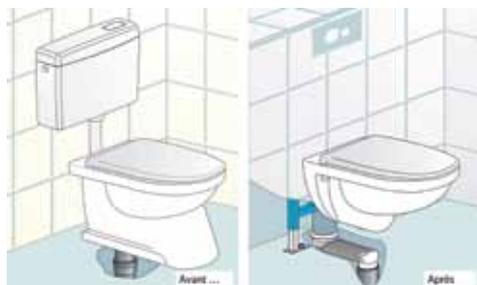
Pour remplacement d'un WC au sol à sortie verticale
