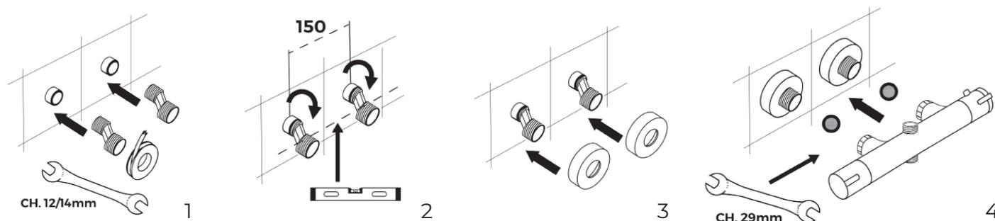
1/ Mettre du ruban d'étanchéité PTFE compatible eau potable.
