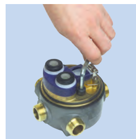
Visser les vis provisoires fournies dans l'emballage ; le mitigeur ainsi transformé devient un by-pass.
