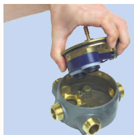
Après avoir retiré manette, capot et vis, sortir l'ensemble tampon/cartouche de son logement.
