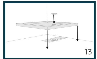
14. Fissare la piletta di scarico, utilizzando le apposite viti.
