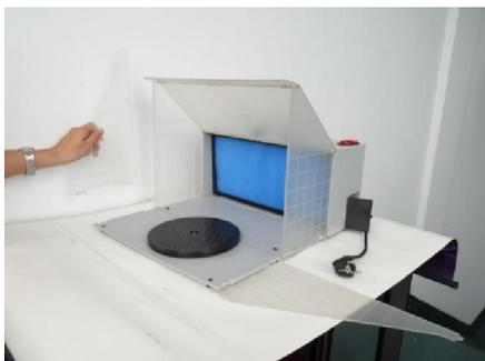
9. Die rechten und linken Seitenplatten können senkrecht eingestellt und heraus genommen werden. Durch den Ausbau jeweils einer Seitenwand kann eine zweite Kabine angeschlossen werden. Dadurch wird der Arbeitsraum verdoppelt.
