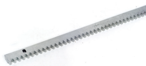
Crémaillère acier zingué M4, 30x12 pour portail lourd, 4 sections de 1m avec fixations à visser
