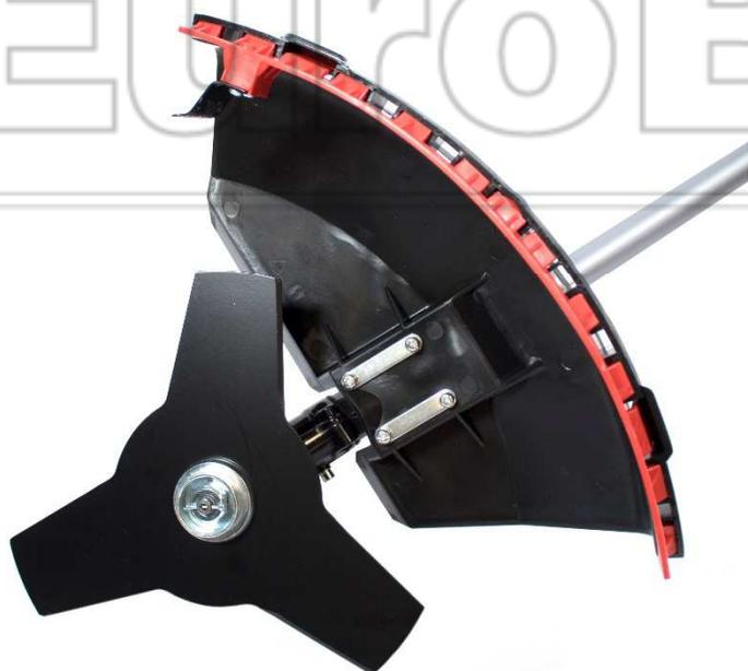
Per l'installazione delle lama a **3 denti** è sufficiente svitare la testina con la bobina del filo, inserire la coppiglia e la lama nel pignone, inserire la seconda coppiglia e bloccare con il dado e il fermo in metallo.
