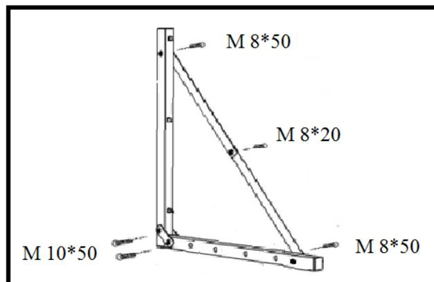
2. Instale los apoyos verticales en la pared: Coloque dos tacos de pared a una distancia de entre 81,3 cm (32") y 121,9 cm (48") (medidos desde el punto central) y asegúrese de que los agujeros estén a la misma altura. Perfore los dos agujeros marcados con una broca de 48 mm (3/16") (M: 32" a 48").
