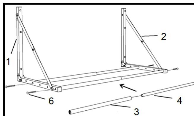
5. Apriete, alinee y pliegue: Todos los elementos de unión deben estar bien apretados. Cuando el soporte para neumáticos no se necesite, pliéguelo.
