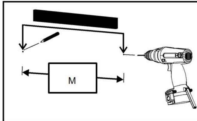
3. Monte las piezas (1) y (2) utilizando tornillos de expansión (5) (no incluidos en el envío debido a las diferentes normas). No apriete demasiado los tornillos superiores. Los soportes deben estar a la misma altura. Equipe con tornillos los dos agujeros restantes (5). Apriete bien todos los tornillos.
