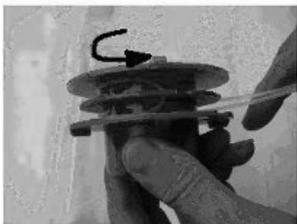
Retire los restos del hilo viejo e inserte un nuevo hilo de nailon, que no debe tener una longitud superior a 2,5 m. Desenrolle completamente el hilo nuevo antes de colocarlo en el centro de la bobina. Asegúrese de que ambos extremos del hilo tengan la misma longitud. Coloque el hilo en la ranura provista y presiónelo hacia abajo.
