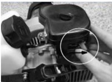
Luego mueva la palanca del carburador a la posición de inicio para activar el acelerador.
