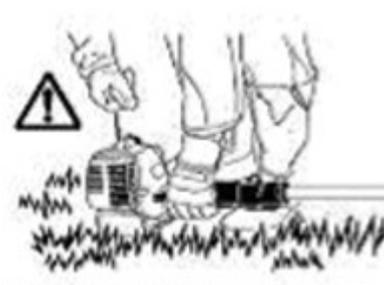
A continuación, presione el botón de inyección 6 veces para asegurarse de que haya suficiente gasolina en las líneas de gasolina.
