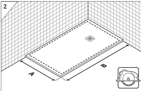
La découpe est réalisée avec une scie circulaire et une lame diamant. Veillez à toujours porter les équipements et protections individuels nécessaires. Les mesures sont prises à l'emplacement final du receveur et reportées sur le receveur.
