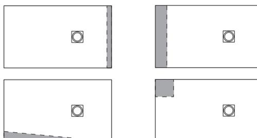
Le receveur The Pop Singer 2 s'ajuste parfaitement à votre espace. Il peut se redécouper sur chacune de ses faces (voir schémas ci-dessus). Les côtés coupés doivent être positionnés côté mur.
