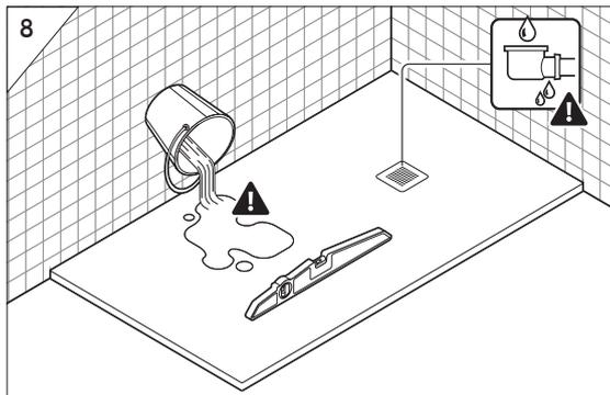
Effectuez un montage à blanc de l'ensemble (bonde et receveur) avant tout montage définitif afin de vérifier la stabilité du receveur, le bon assemblage de la bonde et la bonne évacuation de l'eau. Démontez ensuite les éléments du receveur et procédez au montage final.
