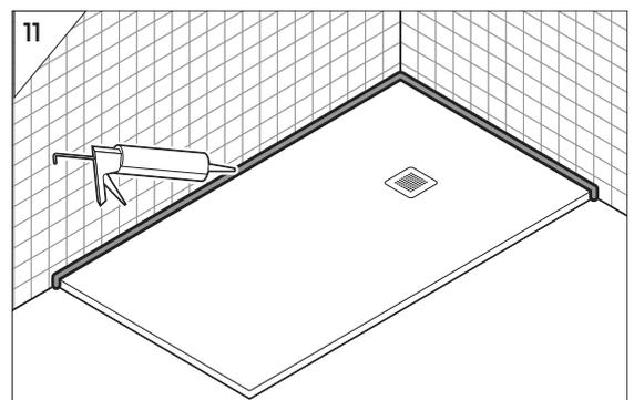
Réalisez également un joint silicone entre le receveur et les murs pour éviter toute infiltration d'eau. Lissez ce dernier pour un meilleur rendu.
