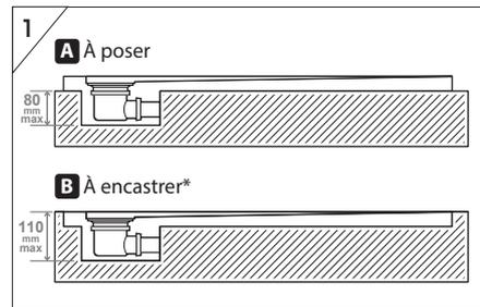
Les deux configurations nécessitent une surface plane et une saignée pour l'installation de la bonde et de l'évacuation.
