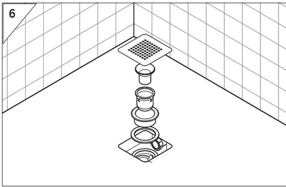
Respectez l'ordre de montage de la bonde (veillez à insérer les joints) et nettoyez le tuyau de l'évacuation sanitaire. Pour le montage de la bonde se référer aux dessins techniques en pages 5 et 6.
