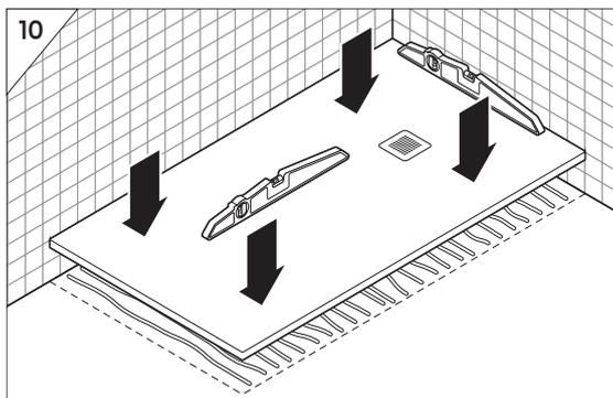
Exercez une pression uniforme sur le receveur lors de sa mise en place. Vérifiez l'horizontalité du receveur avec un niveau au fur et à mesure du collage, il doit être parfaitement de niveau.
