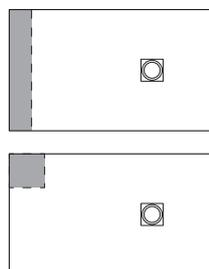
Le receveur O'Rock s'ajuste parfaitement à votre espace. Il peut se redécouper (voir schémas ci-dessus). Les côtés coupés doivent être positionnés côté mur.
