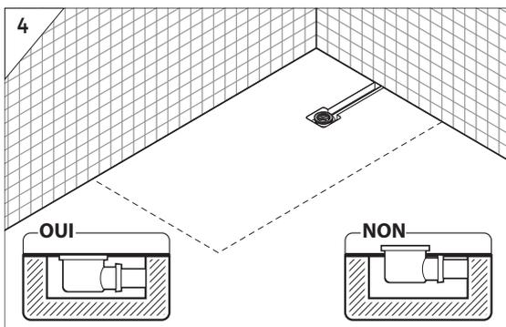
La bonde est à hauteur d'installation et doit pouvoir être reliée au système d'évacuation sanitaire et au receveur sans être ni trop basse ni trop haute (aucun faux aplomb toléré). Tout mauvais montage entraînerait des fuites voire la casse d'un des accessoires d'évacuation et ne serait être pris en compte pour la garantie.
