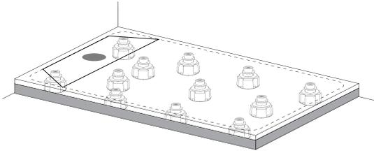
Les plots sont à répartir de façon homogène sur l'ensemble du receveur et à adapter en fonction de la sortie d'évacuation et de la bonde. Leur nombre varie en fonction de la dimension de votre receveur.
