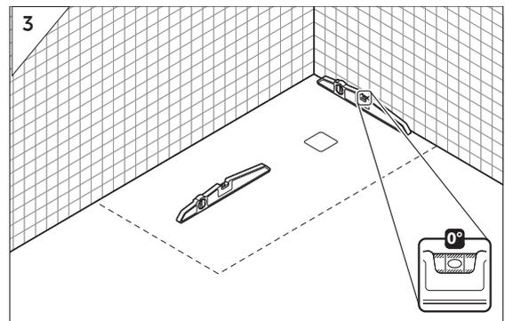
La surface au sol destinée au receveur doit être parfaitement nivelée, lisse et exempte de tout défaut de planéité. Le sol doit être impérativement sec et propre avant l'installation du receveur.
