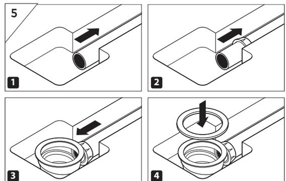
Une saignée suffisamment large et profonde est nécessaire pour le passage du tuyau d'évacuation et de la bonde. La profondeur de la saignée permet la réalisation d'une pente et doit être suffisante pour assurer un bon écoulement des eaux usées (2 cm par mètre minimum ; plus la pente est forte, meilleure est l'évacuation).
