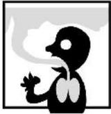
20. Utilice la motosierra sólo en lugares con ventilación adecuada. Nunca arranque o arranque o utilice la máquina dentro de un recinto cerrado o edificio y en una atmósfera potencialmente explosiva. Los gases de monóxido de carbono, es una sustancia altamente peligrosa.
