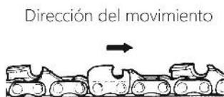
*Nota: Las cadenas nuevas se expande ligeramente al utilizarlas las primeras veces. Verifique frecuentemente la tensión de la cadena. Si la cadena esta floja puede salirse.*
