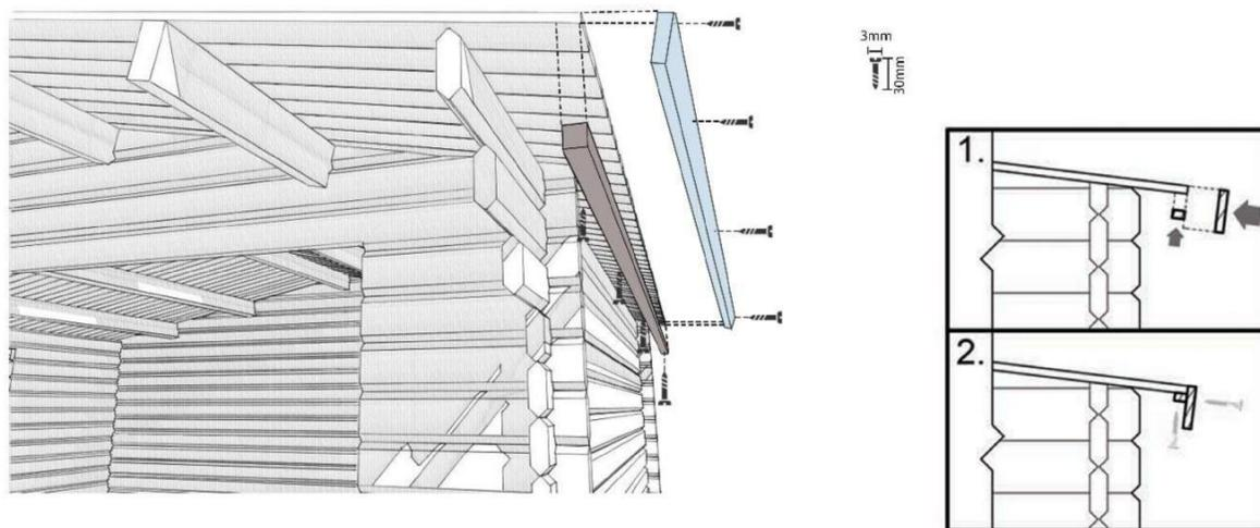
**Placez les planches de rive sur la face avant en les vissant dans les extrémités de chevrons. Idem vérifiez qu'elles ne débordent pas de la toiture. L'extrémité de la planche de rive latérale doit être recouverte par la planche de rive de façade afin de former un angle droit.**
