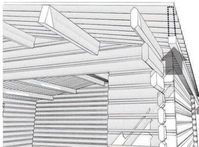
**8. Planches de rive. Placez ensuite les planches de rive pour couverture latérales en les vissant aux planches de lattes sous voliges.**
