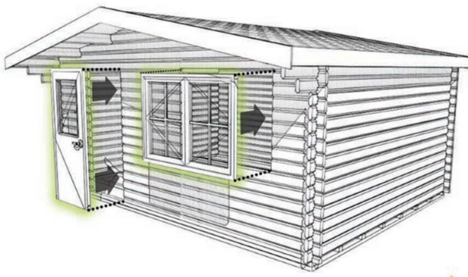
**Insérez ensuite l'encadrement de porte dans l'espace dédié de la structure par l'extérieur et ajoutez le reste des garnitures à l'encadrement par l'intérieur de la structure.**
