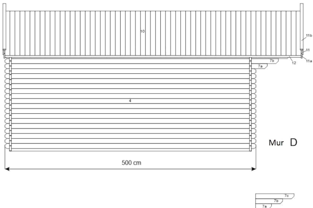
**5. Pignon.** Après avoir assemblé les murs, montez le pignon. Le pignon doit être assemblé avant de le monter sur la structure. Le pignon peut dans certains cas déjà être monté.
