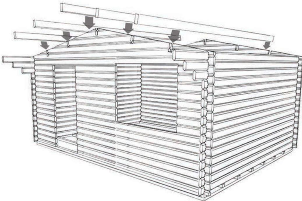
**7. Planches de toit. L'étape suivante est d'attacher les planches de toit (voliges) à la verticale et de les clouer aux chevrons. Vérifiez bien que l'extrémité des planches de toit soit à la même longueur les unes par rapport aux autres et bien positionnées perpendiculairement sur les chevrons.**
