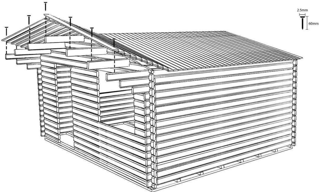
**Fixez ensuite les planches de latte sous volige sous les planches de toit comme montré ci-dessus. Veillez à ce qu'elles soient bien positionnées et ne dépassent pas des planches de toit.**
