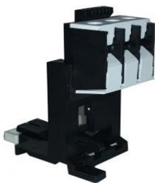
Soporte para montaje de relés térmicos individuales, sin tener que asociar el relé térmico a un contactor. Dota al relé térmico de bornero de entrada para la conexión de los cables de entrada y posibilita la fijación del conjunto mediante tornillos de M4 o bien directamente a carril DIN.
