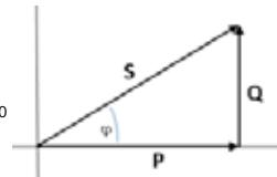
Se non conoscete il f.d.p del vostro apparecchio, tenete presente che i motori elettrici hanno valori compresi tra 0.4 e 0.75, per un dispositivo con un motore da 1kW (P) serve un generatore da 1.4 kVA e 2, 5kVA.
