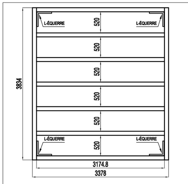
2. Utilisez un contreplaqué pour l'emploi extérieur CDX (19mm), coupez et ajustez les feuilles ensemble pour former une fondation solide tel qu'indiqué. La fondation doit être carrée et nivelée.
