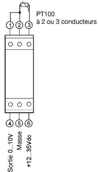
La tension de sortie est linéarisée par rapport au signal de température à l'entrée. Entre la sonde et la tension de sortie/de fonctionnement, il n'existe aucune connexion galvanisée.
