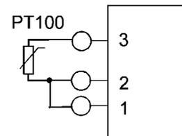
Dans le cas d'un circuit à deux conducteurs, la résistance du câble d'alimentation intervient dans le résultat de la mesure. C'est pourquoi ce branchement n'est conçu que pour de petites longueurs de câble ou de faibles exigences de précision. Entre les câbles 1 et 2, il convient de dresser un pont sur le transmetteur de température.
