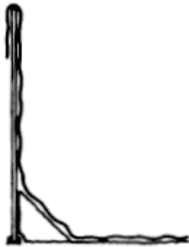
KORREKT KEINE LUFT ZWISCHEN AUSKLEIDUNG UND BECKEN - DURCHHANG AN DEN SEITEN
