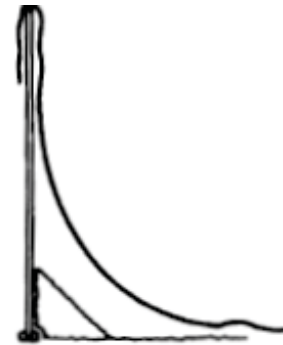
FEHLERHAFT! LASSEN SIE KEINEN PLATZ ZWISCHEN AUSKLEIDUNG UND MULDE. DIES FÜHRT ZU SPANNUNG AN DER AUSKLEIDUNG. KORRIGIEREN SIE DIESE SITUATION GEGEBENENFALLS.
