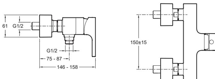
Descriptif CCTP : Mitigeur douche mural. E45371. Collection : STRAYT. POIDS : 3,7 kg. TYPE D'INSTALLATION : Mural. RACCORDS : Avec raccords et rosaces murales. MÉCANISME : Cartouche à disques céramique. TYPE D'INSTALLATION : 2 trous. CLAPET ANTI-RETOUR : Yes. GARANTIE MÉCANISME : 5 ans. Bague-limiteur de température. Clapet anti-retour sur sortie douche.
