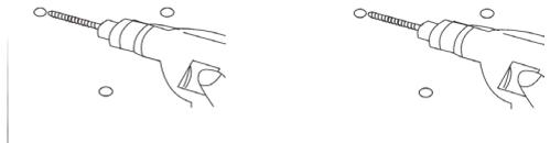
3. Befestigen Sie die Montageklammer. Verwenden Sie 6 Schrauben des Typs ST4x35. Achten Sie darauf, dass die Montagepunkte fest angebracht sind.
