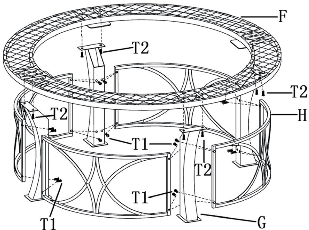
**Schritt 4** Platzieren Sie die Feuerschale auf der so entstandenen Basis. Legen Sie den Rost ein. Ihre Feuerschale ist nun zur Benutzung bereit. Legen Sie den Grillrost (11) zum Grillen ein und/oder setzen Sie die Abdeckung zum Schluss obenauf.
