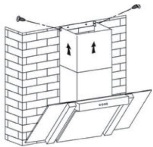
Inserte la chimenea superior en la chimenea inferior. A continuación, saque la chimenea superior hasta la altura deseada.
