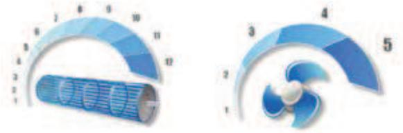
12 velocidades de operación del ventilador interior y 5 del exterior, controlados por el microprocesador, aseguran un control más preciso y brindan un flujo de aire más confortable y silencioso
