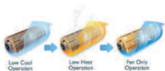
Durante el funcionamiento en frío o secado (Dry), esta función permite secar la batería de la unidad evaporadora para prevenir el crecimiento de moho
