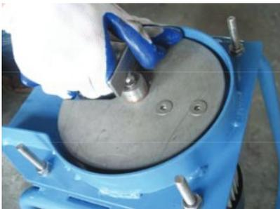
Tenga cuidado al limpiar las cuchillas de corte, ya que pueden causar lesiones debido a su afilado. Asegúrese **SIEMPRE** de que la máquina esté apagada y desconectada de la corriente antes de limpiarla o repararla.
