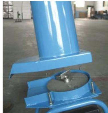
3. Extraiga la placa giratoria, la cual sujeta la placa de corte. Coja la placa de corte **(10)** de la placa base **(15)** y límpiela.
