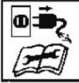
**Desenchufar:** Desconecte el enchufe de la red eléctrica siempre antes de ajustar o limpiar la máquina, o si el cable de alimentación se enreda. Apáguelo también si desea dejar la desatendida la trituradora.
