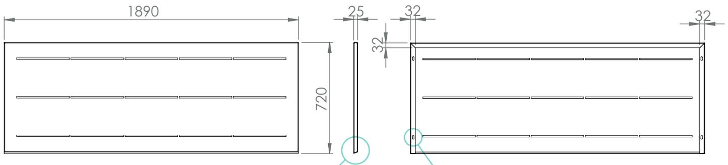
Los acabados de los módulos de valla sobre muro están diseñados para facilitar la eliminación del agua, evitando así la corrosión por factores ambientales
