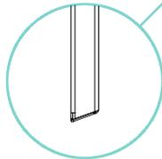
Los colisos de la parte trasera de la valla sobre muro facilitan su instalación, ya que permiten posicionar cada módulo a la altura correcta.
