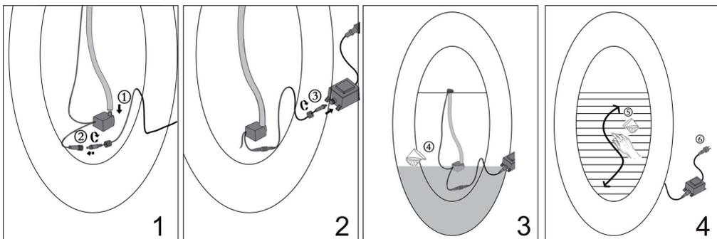
Das Gerät ist schon fertig verkabelt. Die Schritte 1 und 2 brauchen Sie nicht selbst auszuführen, wenn Sie das Gerät zum ersten Mal in Betrieb setzen.
