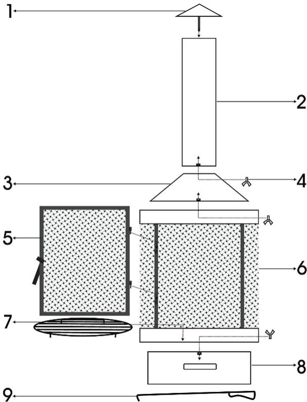
1. Setzen Sie den Abzug (2) auf die Haube (3). Befestigen Sie ihn mit den Schrauben (4).
