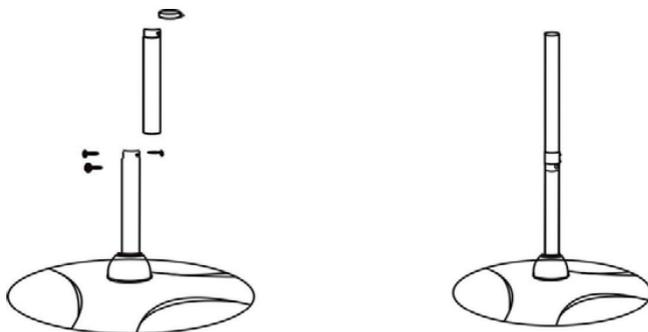
Fixez le tube inférieur au tube large avec trois vis 5x6mm et placez le premier support de câble sur le tube central.
