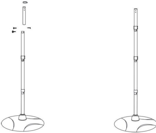
Fije el cuarto conducto del mismo modo que se describe en el paso 3 y coloque el tercer soporte del cable en el cuarto conducto.
