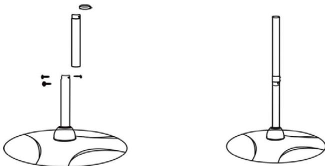
Fissare il tubo inferiore e il tubo centrale utilizzando tre viti 5\*6 mm e mettere il primo portacavo sul tubo centrale.
