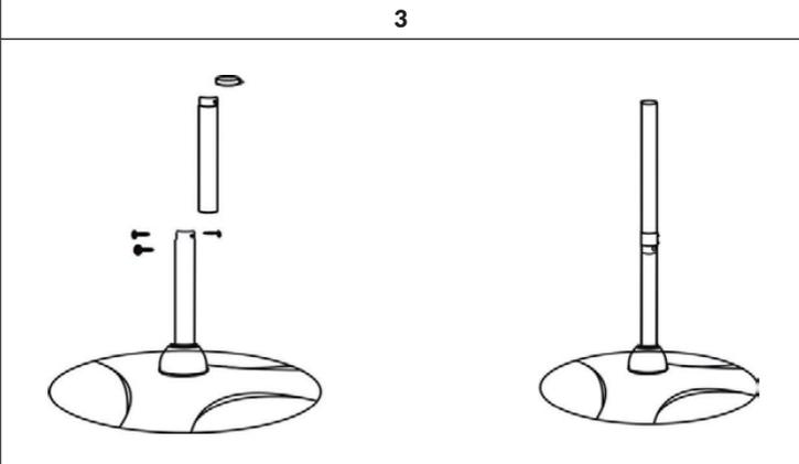
Befestigen Sie das untere Rohr mit drei 5\*6 mm Schrauben am weiten Rohr und setzen Sie die erste Kabelhalterung auf das Mittelrohr.
