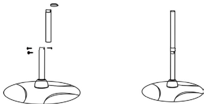
Fije el conducto inferior con tres tornillos 5x6 mm al conducto ancho y coloque el primer soporte del cable en el conducto intermedio.
