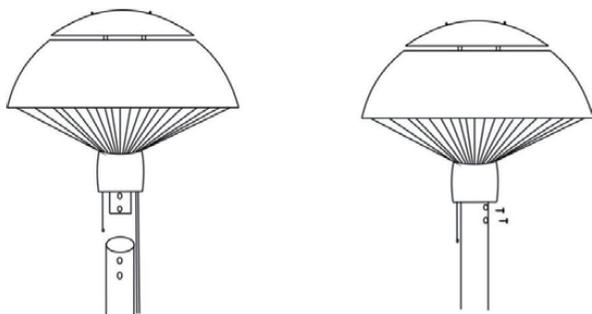
Fissare l'elemento riscaldante al tubo superiore utilizzando due viti 4\*12 mm.
