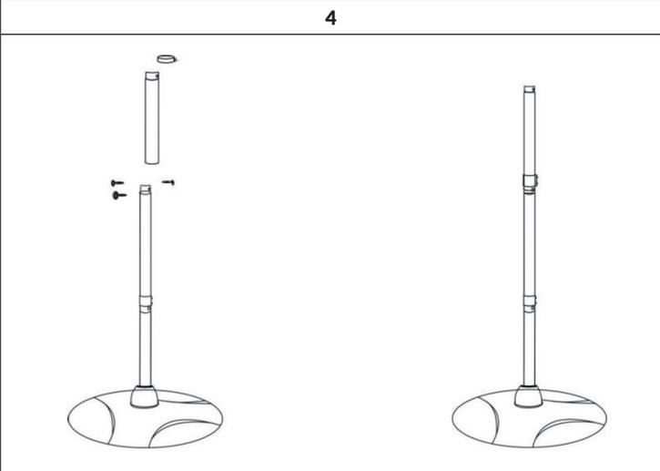
Befestigen Sie das dritte Rohr auf die gleiche Art, wie in Schritt 3 beschrieben, und setzen Sie die zweite Kabelhalterung auf das dritte Rohr.
