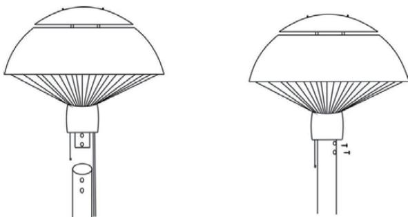
Befestigen Sie den Heizkopf mit zwei 4\*12 mm Schrauben am obersten Rohr.
