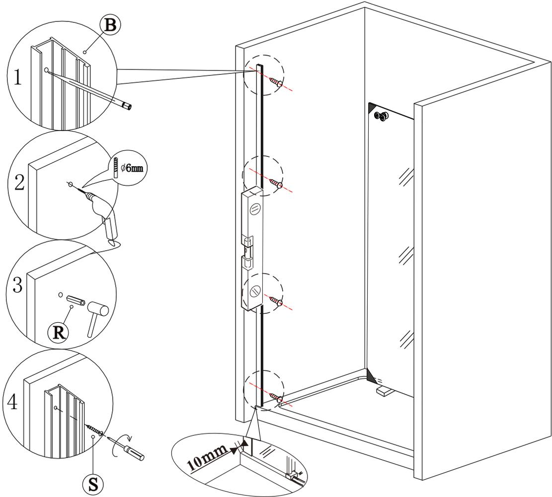
Instalar el perfil de pared por lo menos 10mm del borde del plato de ducha, así dar espacio para instalar el guía del cristal.
