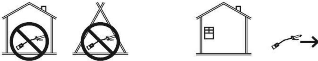
**Attention !** Ce désherbeur thermique doit être employé uniquement avec du propane HD-5. Le réservoir de propane ne doit pas contenir plus de 20 livres de gaz LP. N'utilisez pas de grands récipients à plus haute capacité. N'utilisez aucun autre genre de gaz.
