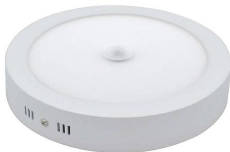
Plafón con SENSOR DE MOVIMIENTO de superficie LED fabricado en aluminio + PMMA. Con un acabado blanco y una potencia de 18W es un producto especialmente para zonas de paso. Posee un rango de alcance de 6 metros y un tiempo de funcionamiento de detección de 30 segundos. El sensor se activa siempre que detecta movimiento. Se caracteriza por su Detector de Presencia y de Luminosidad.
