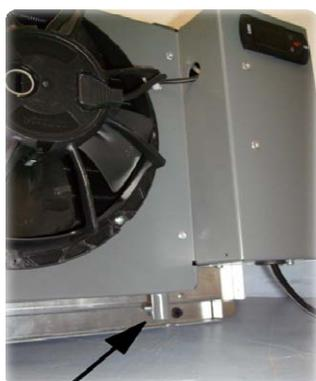
Écoulement du bac de récupération des condensats
