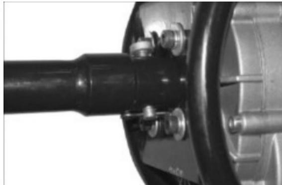
Alinee el eje de transmisión del motor con el asiento de la barrena y fíjelo utilizando el bulón de pistón y el pasador adecuados.
