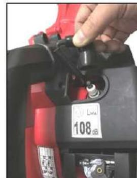
Retirez la bougie avec la clé à bougie livrée avec la machine – cette clé dévisse dans le sens contraire des aiguilles d'une montre.
