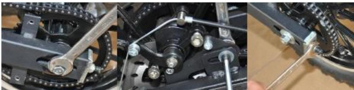
**Paso 3:** la tensión de la cadena estará en buenas condiciones si la separación entre la cadena y las partes más bajas del brazo oscilante es de aproximadamente 5 mm. Bloquee todas las tuercas y tornillos, verifique la alineación de la rueda y finalmente vuelva a colocar la cubierta de la cadena.
