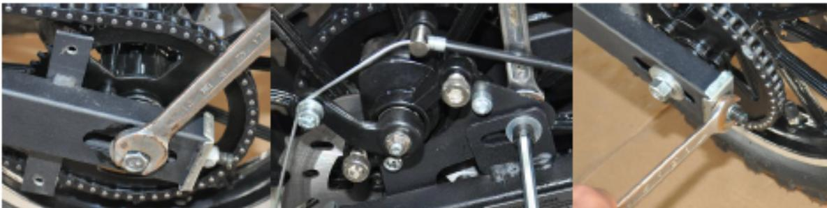
**Paso 3:** la tensión de la cadena estará en buenas condiciones si la separación entre la cadena y las partes más bajas del brazo oscilante es de aproximadamente 5 mm. Bloquee todas las tuercas y tornillos, verifique la alineación de la rueda y finalmente vuelva a colocar la cubierta de la cadena.
