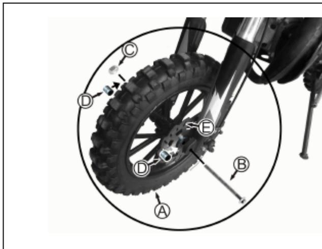
1. Coloque la rueda (A) en la posición que permita colocar correctamente el disco (E) entre la pinza de freno.
