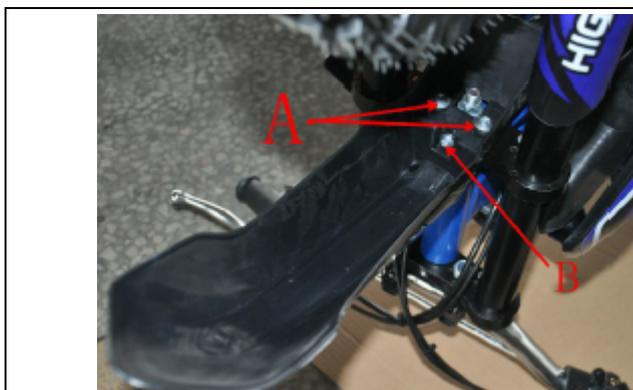
1. Monte 2 tornillos/pernos M6x16 (A) en el pliegue hacia abajo y apriételos.
