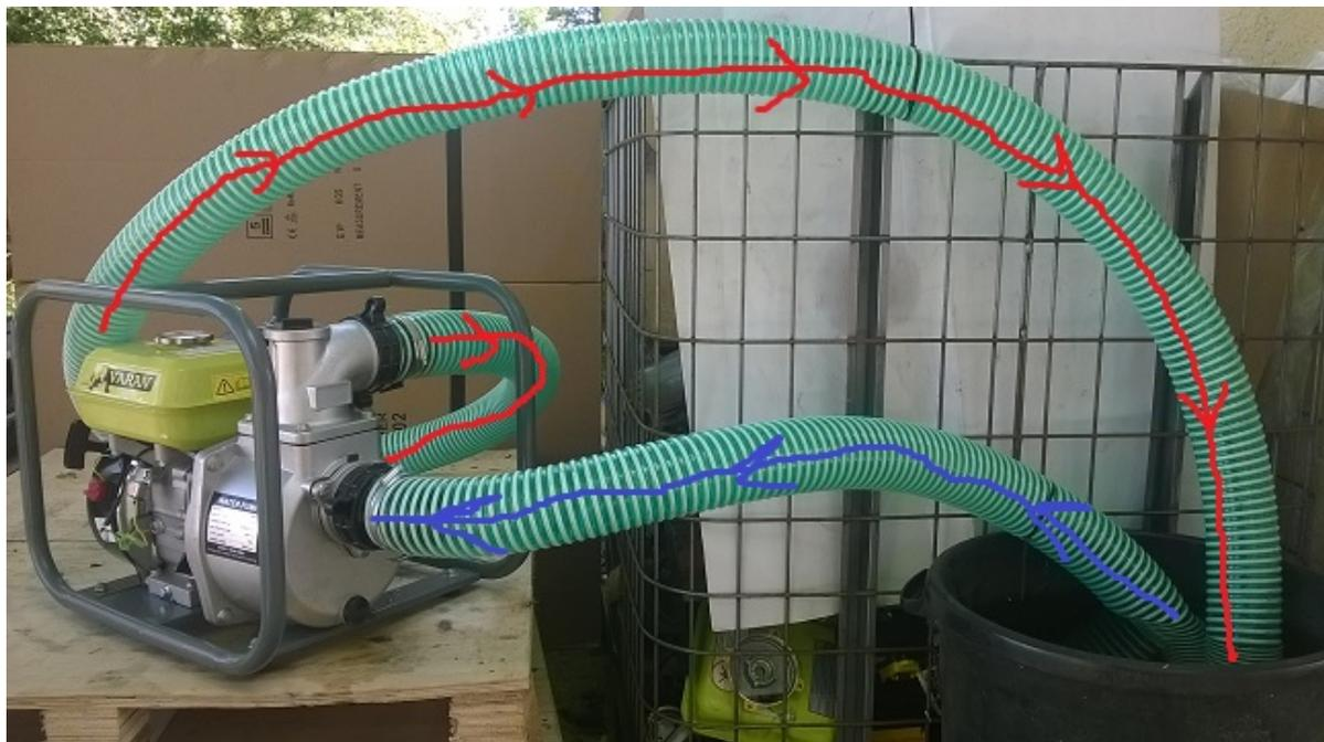
Pour amorcer la pompe, prévoyez un tuyau rigide en entrée (pas de souple !) et un tuyau en sortie. Raccordez-les correctement de manière hermétique pour éviter toute prise d'air.
