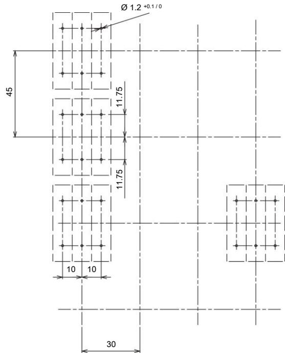
Blocs à contacts raccordement à vis
