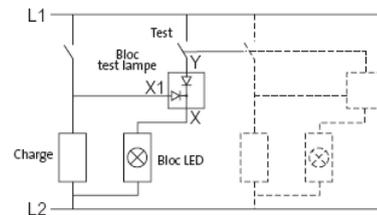
Pour alimentations 130V et 230V AC – ensemble « test + led »
