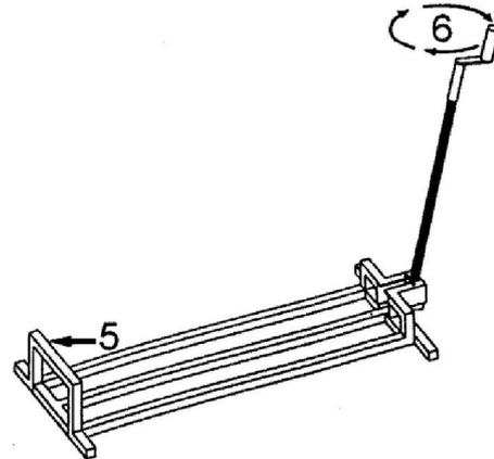
Au cas où vous soulevez la tondeuse et qu'elle n'est pas droite, tournez la manivelle dans le sens inverse des aiguilles de la montre pour remettre la tondeuse sur le sol. Remettez la tondeuse dans une position correcte et recommencez l'opération à nouveau
