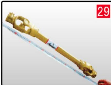
**Vérifiez la longueur de l'arbre de prise de force dans les positions minimale et maximale de la machine. Les tubes d'entraînement doivent se chevaucher sur  $\frac{1}{3}$  de leur longueur dans les conditions de fonctionnement ; les tubes de protection ne doivent pas se séparer pendant le fonctionnement !**
