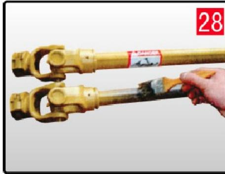
5. Graissez le tube d'entraînement interne et réinstallez le bouclier sur la prise de force.
