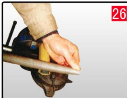
3. Ébavurez les bords du tube d'entraînement avec une lime et retirez tous les copeaux.
