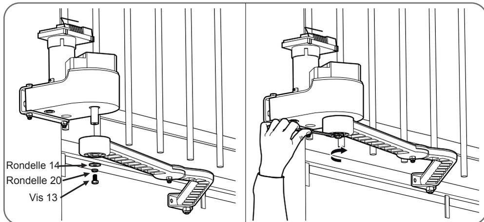
Débrayage du moteur :
