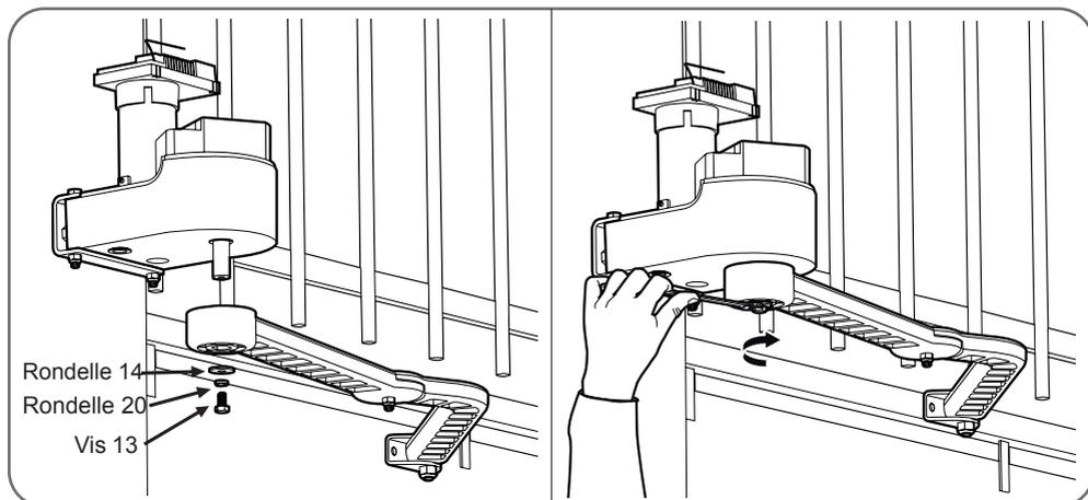
Débrayage du moteur :
