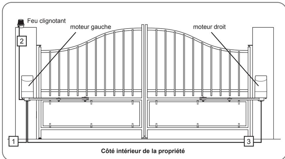
Astuce : si l'arrivée électrique 230V se trouve déjà sur le pilier de droite, il est possible de monter le moteur gauche (qui contient l'électronique de commande) sur le pilier de droite et le moteur droit sur le pilier de gauche. Il suffira d'inverser la polarité de branchement des moteurs pour inverser le sens de rotation par rapport au montage décrit dans cette notice (montage normal avec moteur gauche à gauche et moteur droit à droite).
