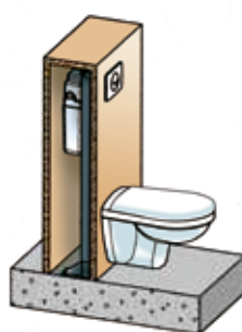
Installation sur sol porteur
