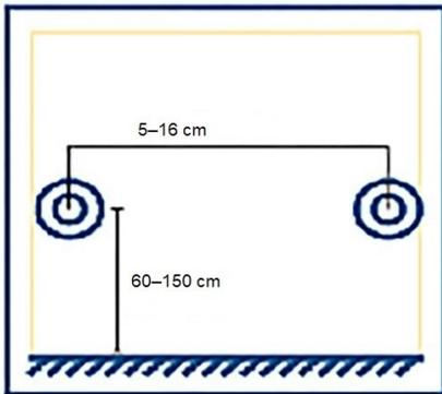
Conditions d'installation : La distance entre les tuyaux d'arrivée d'eau chaude (H) et froide (C) est de 5 à 16 cm. La distance par rapport au sol est de 60 à 150 cm.
