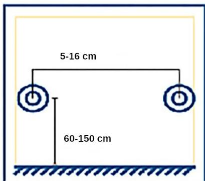
Conditions d'installation : La distance entre les tuyaux d'arrivée d'eau chaude (H) et froide (C) est de 5 à 16 cm. La distance par rapport au sol est de 60 à 150 cm.
