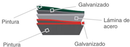
Paneles de pared, techo y puertas: Plancha de acero galvanizado de 0,22 mm.
