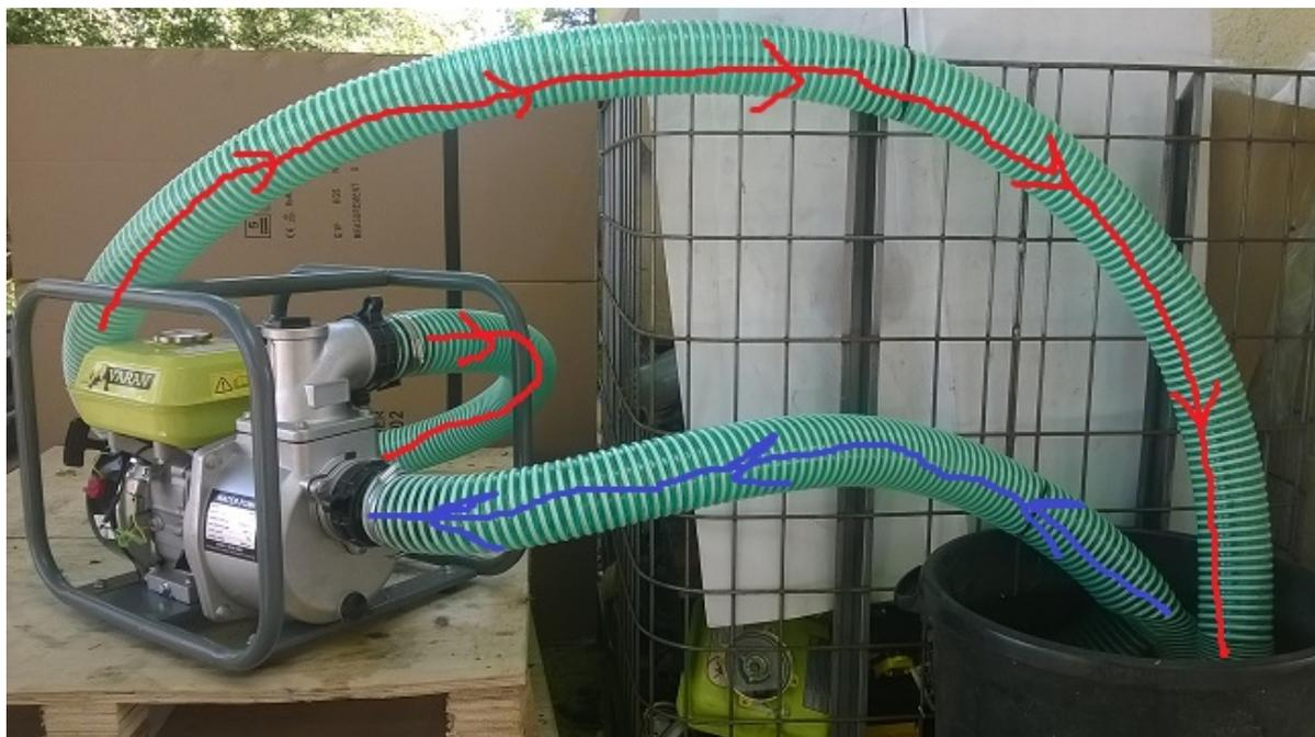
Para cebar la bomba, equípese de una manguera rígida en la entrada de aspiración. (No una manguera blanda!) Y una manguera en la salida. Conéctela de manera hermética para evitar cualquier toma de aire.
