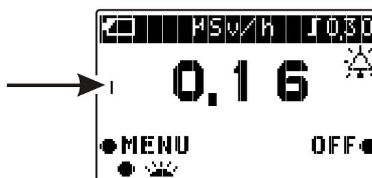
Le cycle court de mesures est égal à la moitié du cycle complet et est destiné à l'obtention rapide des résultats préliminaires. Le premier résultat vérifiable après la mise en marche du produit est visualisé 1-26 secondes après selon le DED et est visualisé avec le pictogramme
