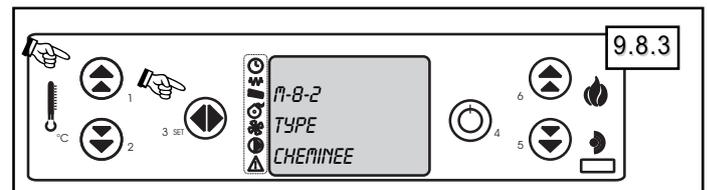
Lors de la mise en service (cf § 3.6; logigramme 1.B), ou si la combustion est fortement modifiée en changeant de type de granulés (nouvelle marque, nouvel approvisionnement), modifier la valeur diminuée (-) ou augmentée (+) le débit d'air de combustion entre -25 et +15%.
