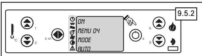
MODE AUTO : fonctionnement économique. Le poêle s'éteint après un délai de quelques minutes (cf § 6.4 Extinction) lorsque la température de consigne est atteinte (cf § 9.4) et se rallume automatiquement lorsque la température ambiante est inférieure à la température consigne (- 1°C) après un délai fixe.
