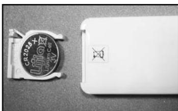
Télécommande : remplacement de la pile 3V CR2025
