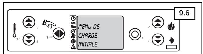
L'appareil doit être éteint (OFF). Appuyer sur "1" pour commencer le chargement des granulés.
