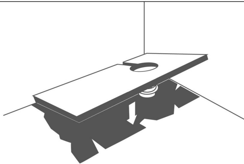
**4** Positionner le joint de bonde, coller et plaquer le receveur à carreler sur la réhausse.
